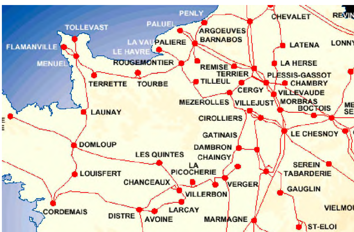
Réseau électrique à 400 000 volts de l'Ouest de la France
