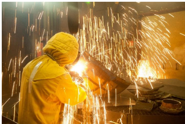
CENTRACO Cyclife - Découpe thermique avant fusion – © EDF-Robert FAHL
