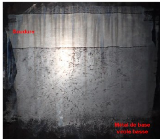
Figure 10 : VB 335 – macrographie de la jonction virole basse / virole médiane
